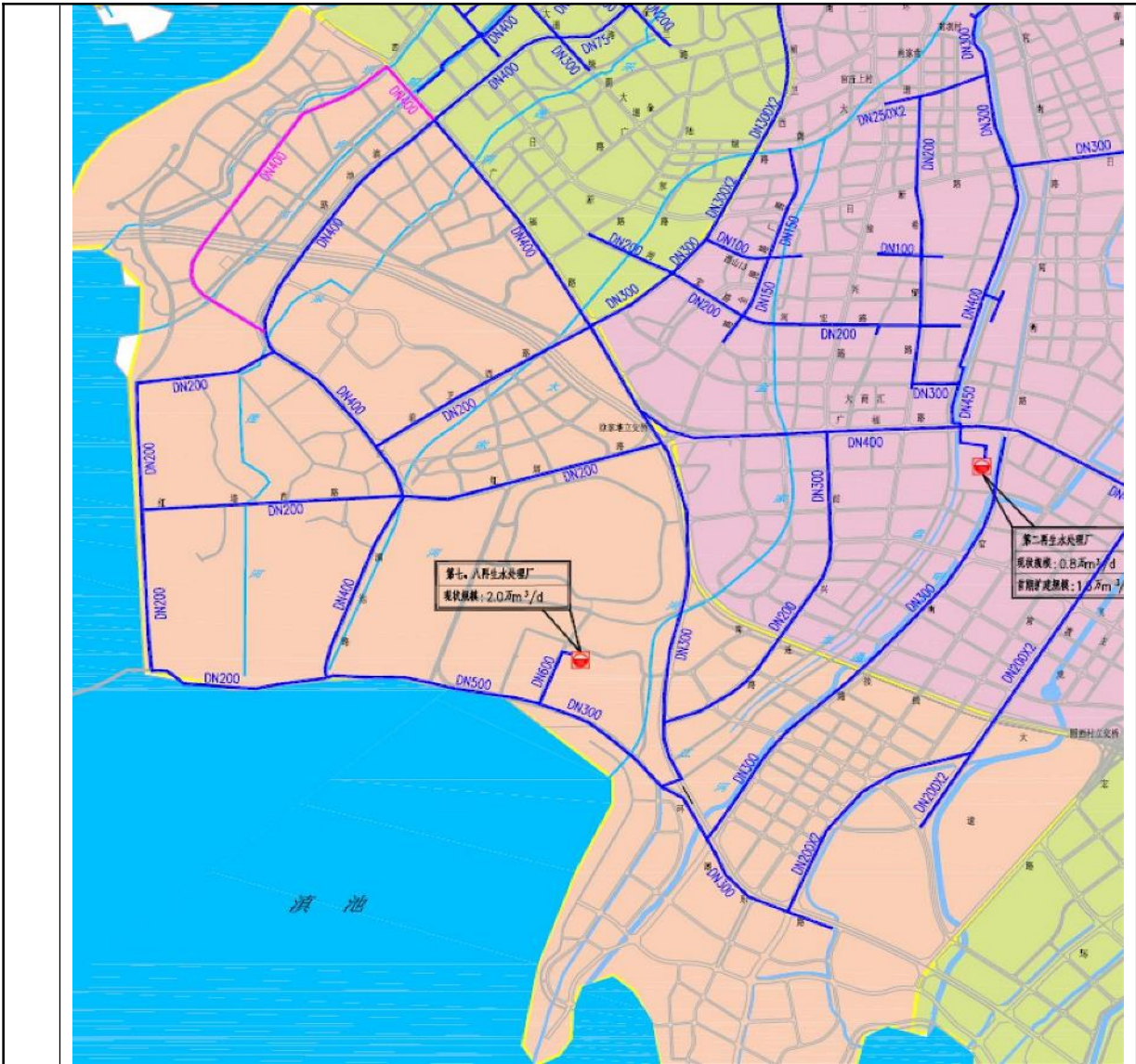
图 2-13 第七、八再生水厂现状管网示意图
